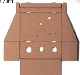
Embalagem de Papelão cortado com dispositivo de facas Zünd
