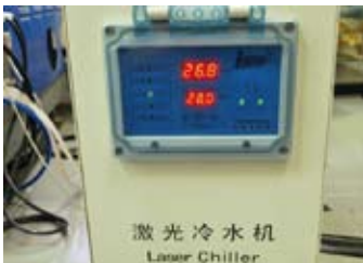
Resfriamento por chiller, garantindo maior estabilidade e durabilidade do canhão laser.
