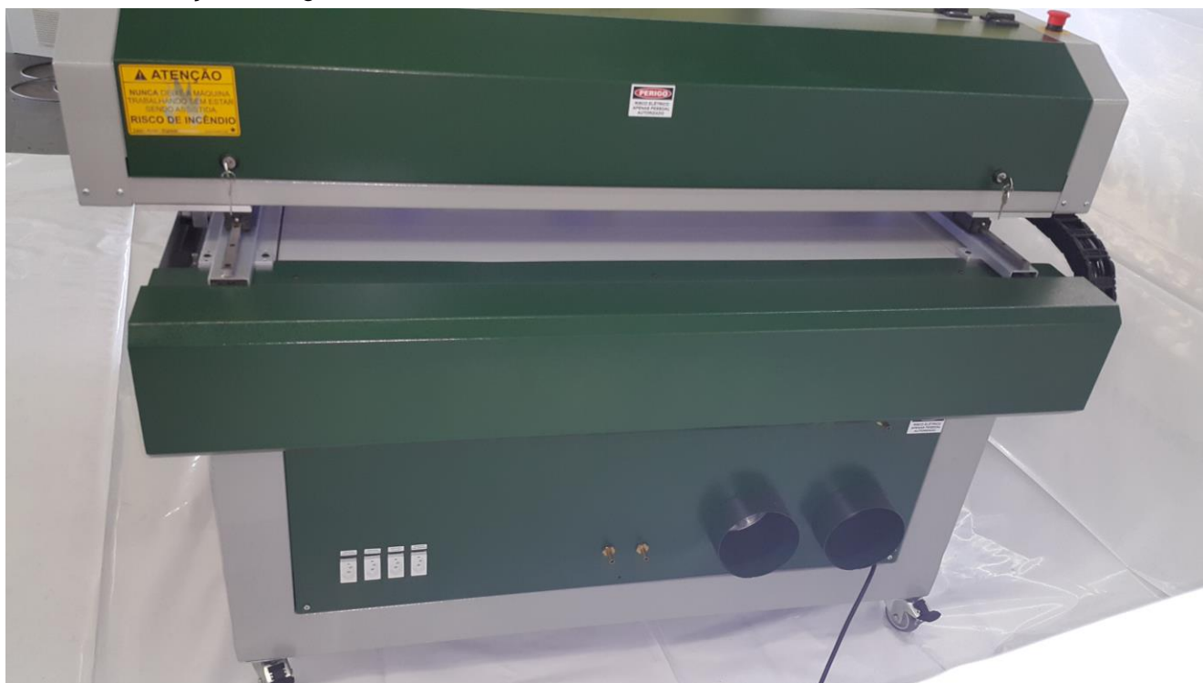
Traseira com tomadas para chiller, 2 exaustores, air assist, tubulações para conexão de exaustores e chiller (todos itens acompanham a máquina)
