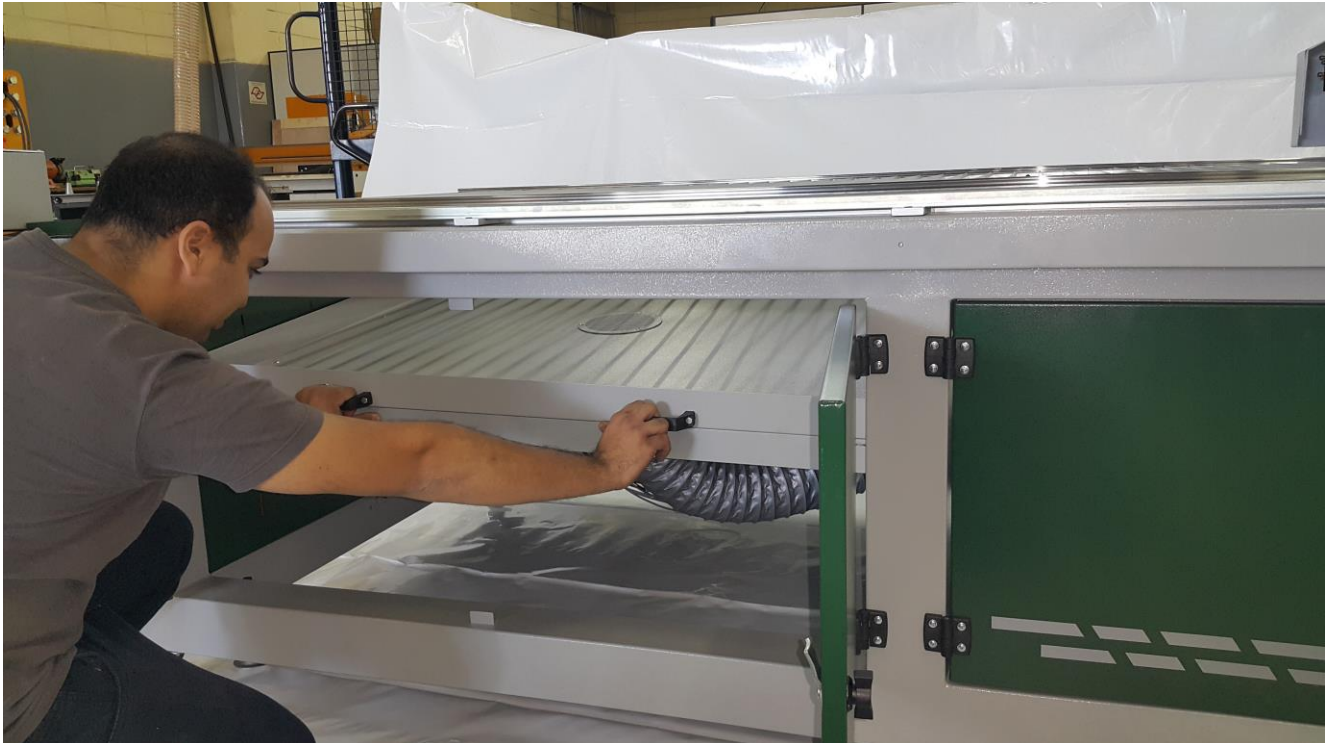
Bandeja inferior basculante para remoção de peças pequenas cortadas
